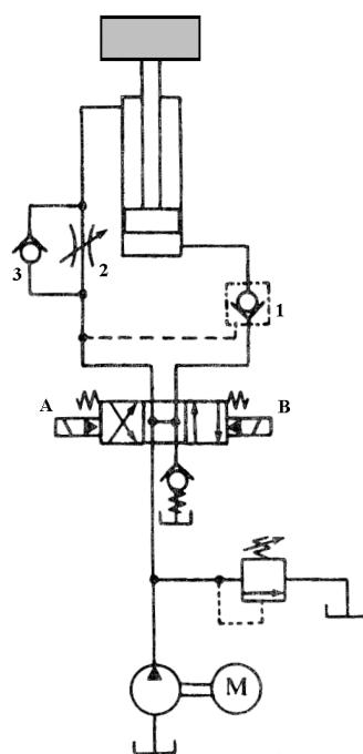
۲- در طراحی مدار مقابل، هدف قفل شدن جک و بار در هر وضعیت مورد نظر و کنترل سرعت در کورس برگشت می باشد. آیا این موضوع محقق خواهد شد؟ اگر پاسخ مثبت است، عملکرد مدار را تشریح و اگر نه پس از بیان علت، مدار را تصویر نموده و سپس آن را تشریح کنید. (۳)
