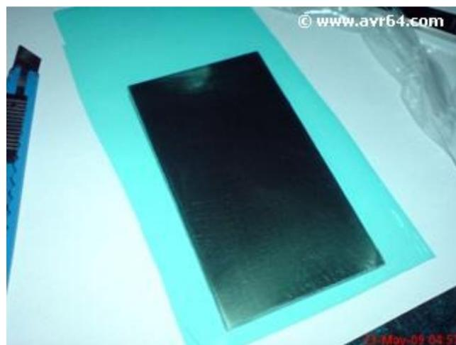
پس از کشیدن کامل لامینت روی فیبر حدود 5 الی 10 دقیقه با دست روی لامینت بکشید تا گرم شده و محکم به فیبر بچسبد (هر چه قدر بیشتر این کار را انجام دهید احتمال جدا شدن لامینت در طی کار کمتر است. در صنعت از لامینتور یا همان دستگاه پرس کارت که روی حرارت کم قرار داده شده برای این کار استفاده می کنند. استفاده از اتو نیز موثر است ولی باید روی درجه کم قرار داده شده و بین آن و فیبر پارچه مرطوب قرار گیرد). پس از اتمام کار فیبر را برعکس کرده و لامینت های اضافی را با تیغ ببرید.
