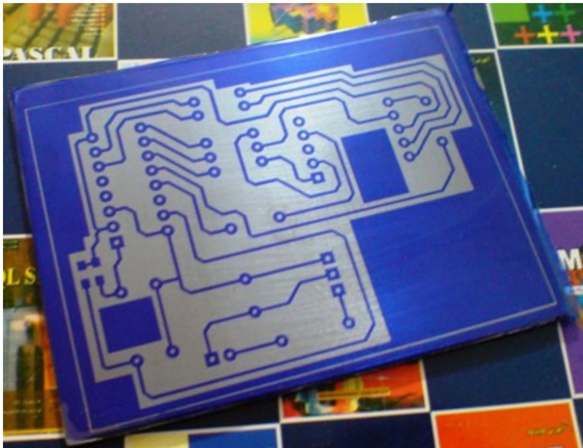
اصلًا برای ساخت مدار های چاپی روش های مختلفی وجود دارد. ساده ترین روش استفاده از مازیک ضد آب برای رسم خطوط روی فیبر مسی می باشد. روش دیگر استفاده از لتراست (حروف برگردان مخصوص) برای طراحی علائم روی قسمت مس فیبر است. هر دو روش ذکر شده برای ساخت مدارات کوچک و ساده مناسب می باشند ولی برای مدارهای پیچیده میکروکامپیوتری و میکروکنترلری و همچنین برای زمانی که تصمیم داشته باشیم نمونه های زیادی از پروژه را تولید کنیم روش های بالا کارآمد نخواهد بود.
