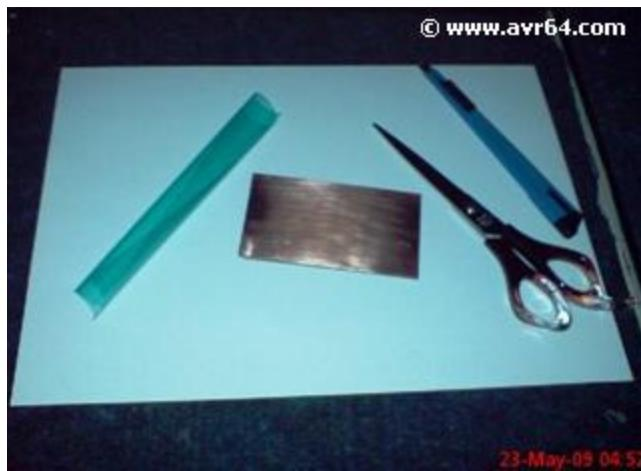
مهم ترین بخش کار، کشیدن لامینت روی فیبر می باشد. لامینت یک ورق پلاستیکی سبز یا آبی با دو مشمای نازک در دو طرف آن می باشد. مشمای یک طرف نرم بوده و حالت کشسانی دارد و مشمای سمت دیگر حالت زرورق داشته و به محض جدا شدن صدا می دهد. عموماً لامینت را به سمت مشمای نرم آن می پیچانند ولی 100% قابل تضمین نیست. در هر صورت با یک تیغ نازک مشمای هر طرف را کمی جدا کرده و در صورت مطمئن شدن مشمای نرم تر را تا نصف جدا کنید.
