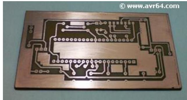
در تصویر زیر مدار ساخته شده را مشاهده می فرمایید. این فیبر مربوط به پروژه Wave Player می باشد و همانطوریکه مشاهده می فرمایید خروجی سیلک اسکرین نرم افزار PCB نیز روی یک لیبل پرینت شده و روی فیبر چسبانده شده است.
