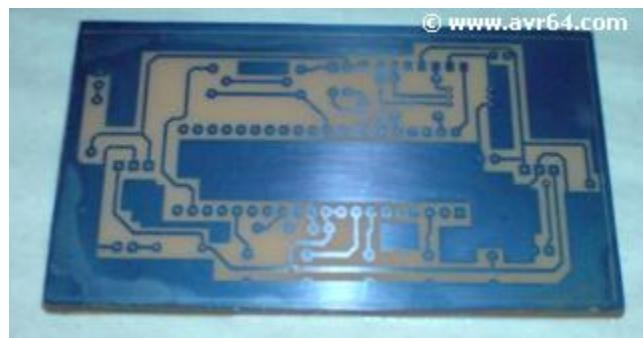
در مرحله بعد نوبت به پاک کردن لامینت از روی بخش های مسی می رسد. می توانید این کار را با تیغ و سنباده و ... انجام دهید ولی به دلیل مقاوم بودن لامینت بهترین روش برای از بین بردن لامینت های اضافی استفاده از سود سوز آور می باشد. (سود سوز آور را می توانید از مغازه های لوازم آزمایشگاهی تهیه کنید). مقدار **یک سوم** فاشق غذا خوری سود را در طرفی به اندازه ظرف ظهور ریخته و در آن نیم سانتی متر آب بریزید. (برای جلوگیری از تداخل از دو ظرف جدا برای ظهور و سود استفاده نمایید).
