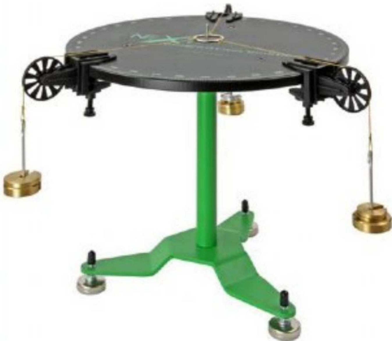
شکل (۲): میز نیرو با سه قرقره از نمای روبرو
