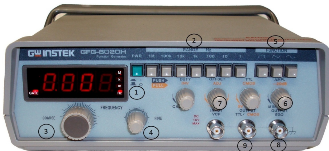
شکل (۲): قسمت‌های مختلف یک سیگنال ژنراتور
