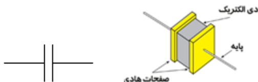
شکل (۱): علامت اختصاری و قسمت‌های مختلف خازن
