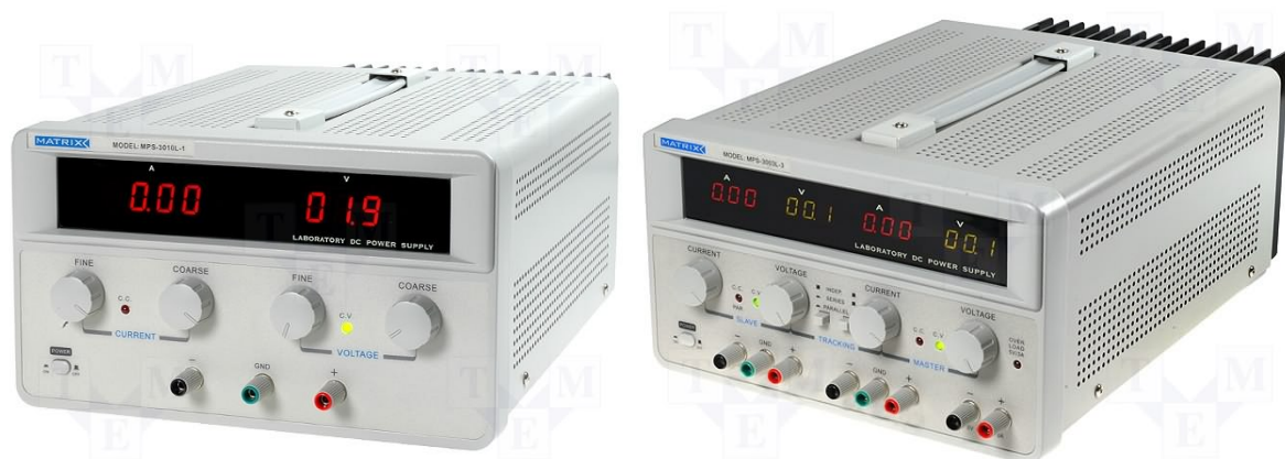
شکل (۱): منبع تغذیه DC سمت راست دو کاناله، سمت چپ تک کاناله
