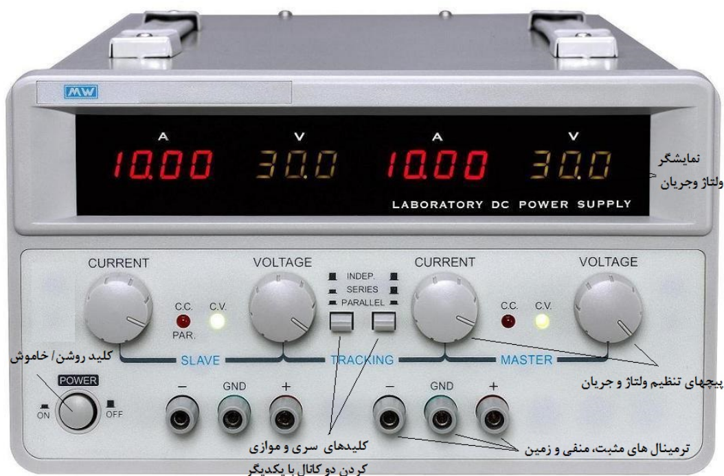
شکل (۲): قسمت‌های کلی یک منبع تغذیه DC
