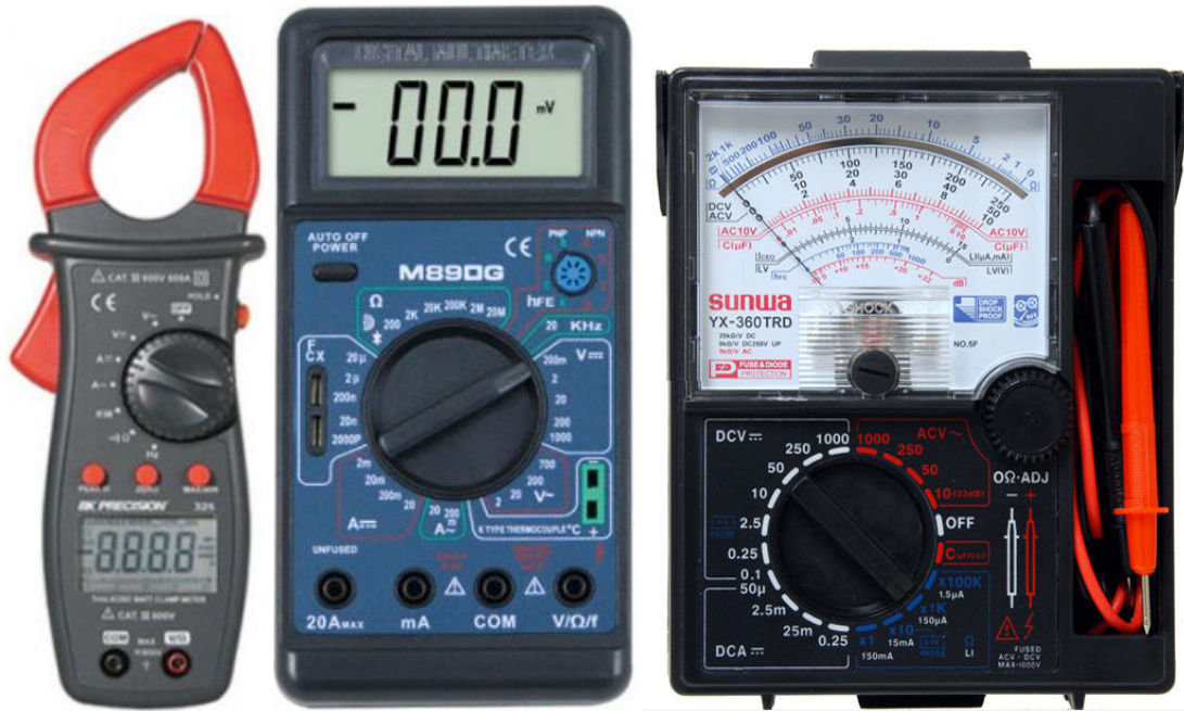
شکل (۱) : نمونه‌ای از انواع مولتی مترها از راست به چپ مولتی متر آنالوگ، دیجیتال، انبری
