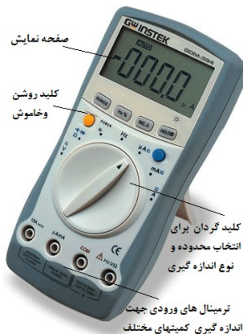
شکل (۲): قسمت‌های کلی یک مولتی‌متر دیجیتال
