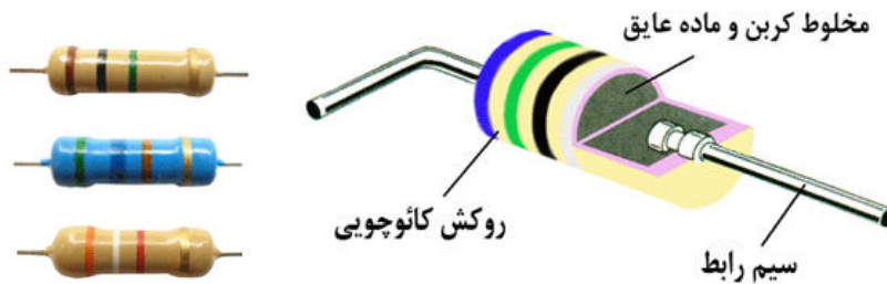
شکل (۴): نمونه‌هایی از این انواع مقاومت و ساختمان داخلی مقاومت کربنی
