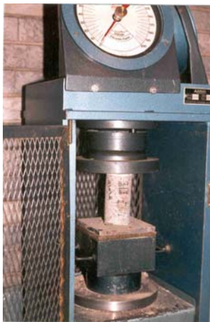
شکل ۹ - شمای کلی دستگاه بارگذاری
