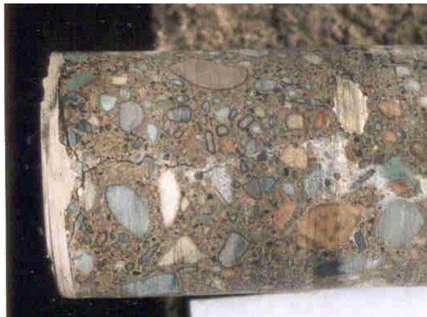
شکل ۱۵ - یک نمونه مغزه از ترک تزریق شده
