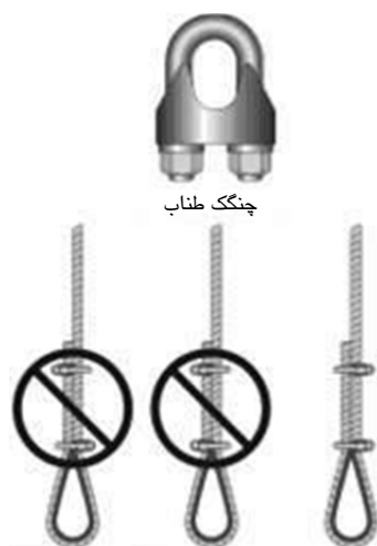
شکل ۵-۱۴۹- روش مناسب چنگک طناب سیمی
