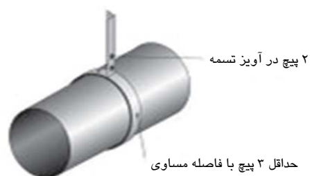
شکل ۵-۸۵- مهار تسمه‌ای برای کانال دایروی با مهاربندی فولادی
