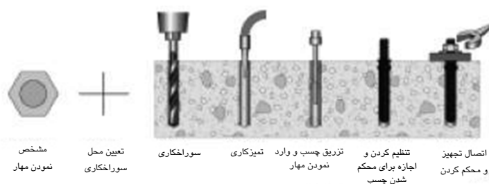
شکل ۵-۱۳۲- مراحل نصب مهارهای چسبنده
