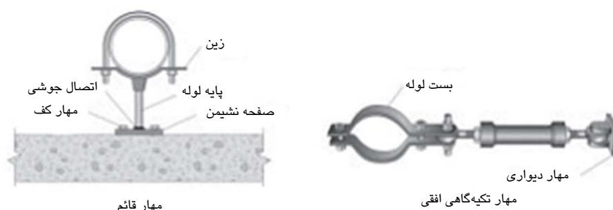
شکل ۵-۱۶۸- جزئیات مهاربندی لوله
