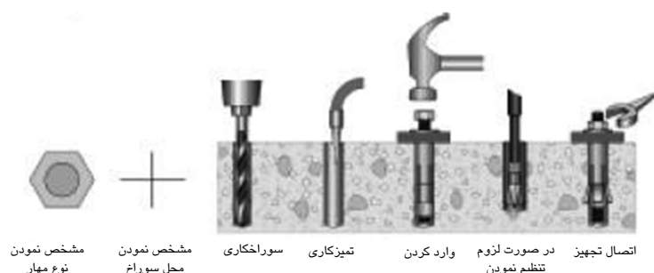
شکل ۵-۱۳۱- مراحل نصب مهارهای غیرچسبنده
