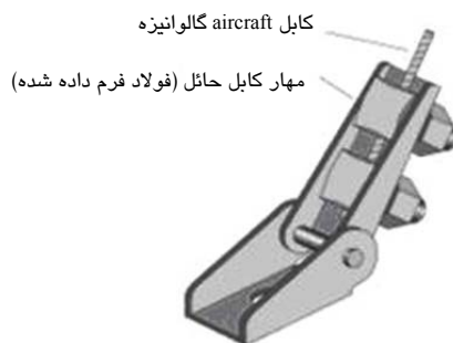
شکل ۵-۱۴۶- کابل متصل شده به سگدست با پیچ
