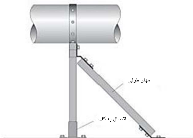
شکل ۵-۹۰- کانال‌ها و لوله‌های مهار شده بالاتر از کف توسط پایه
