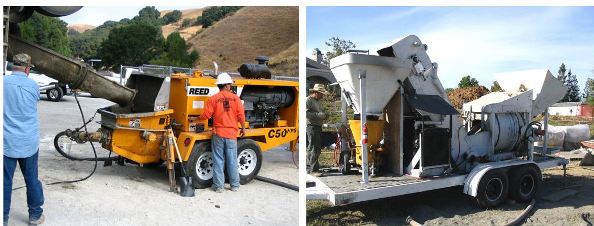
شکل ۵: تصویر سمت راست دستگاه خشک پاش و تصویر سمت چپ دستگاه تر پاش می‌باشد
