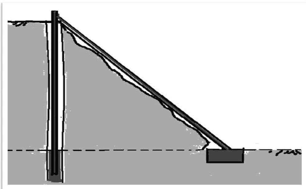
8- خاک محصور بین اعضای قائم و افقی خرپاهای (سپر خاکی)، به صورت مرحله‌ای گودبرداری شده و در هر مرحله اعضای افقی و قطری نصب می‌شوند تا خرپا تکمیل گردد. توجه گردد که در صورت وجود فاصله بین عضو قائم و ملک مجاور حتماً بایستی در هر مرحله گود برداری این قسمت با مصالح مناسب پر گردد تا فشار خاک به خرپا منتقل گردد (مصالح مناسب مصالحی است که حداقل مقاومت فشاری خاک آن قسمت را دارا باشد).
