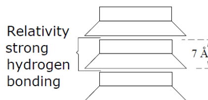
شکل ۱-۸ نحوه پیوند واحدهای پایه کانی کائولینیت
