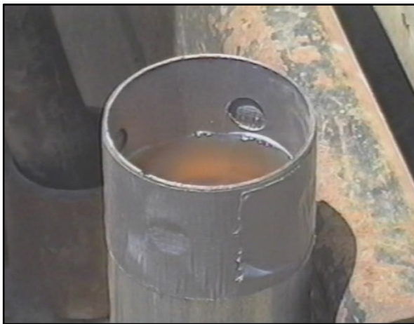
شکل ۲-۲۱ آب بند کردن نمونه های دستنخورده شلبی
