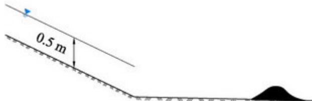
۶- جریانی در کanal مستطیلی و بتنی با شیب ۱/۰۰۰، عمق جریان ۲/۲ متر و عرض ۱/۰ متر برقرار است. این کanal در مسیر خود یک تغییر شیب به شیب تند تر داشته است بطوریکه عمق جریان به ۰/۵ متر در کanal پر شیب رسیده است.
